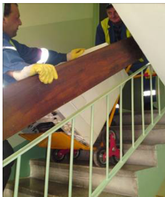
Rysunek 5. Transport ciężkich i niewygodnych przedmiotów po schodach z wykorzystaniem trójkołowego wózka, wykonywany przez jednego pracownika firmy SITA (fot. M. Zdrodowski) (Figure 5. Carriage of heavy and bulky items up the stairs with the use of a three-wheeled trolley, performed by one employee of SITA company [photo M. Zdrodowski])
