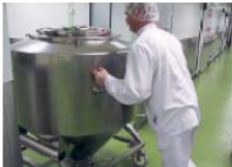
Rysunek 2. Przed zmianą – ręczny transport kontenera o wadze do 510 kg (fot. M. Zdrodowski) (Figure 2. Before the change – the manual transport of the container weighing up to 510 kg [photo M. Zdrodowski])
